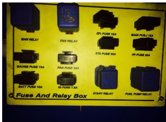
Hình 6.1.2: Vị trí hộp ECU điều khiển, hộp nguồn cầu chì và relay
