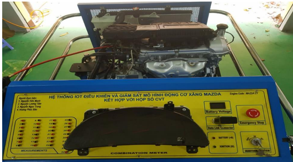
Hình 3.2: Mô hình động cơ xăng Mazda kết hợp với hộp số CVT
